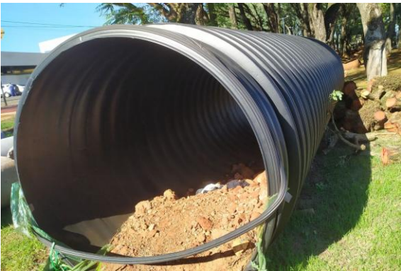
Foto 08 – Tubo PEAD (sobressalente, para ilustração)
